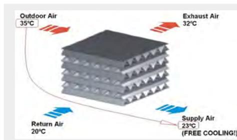
La figura mostra la struttura dello scambiatore di calore a flussi incrociati che, composto da sottilissimi fogli sovrapposti, consente il trasferimento di energia tra i due flussi d'aria.
